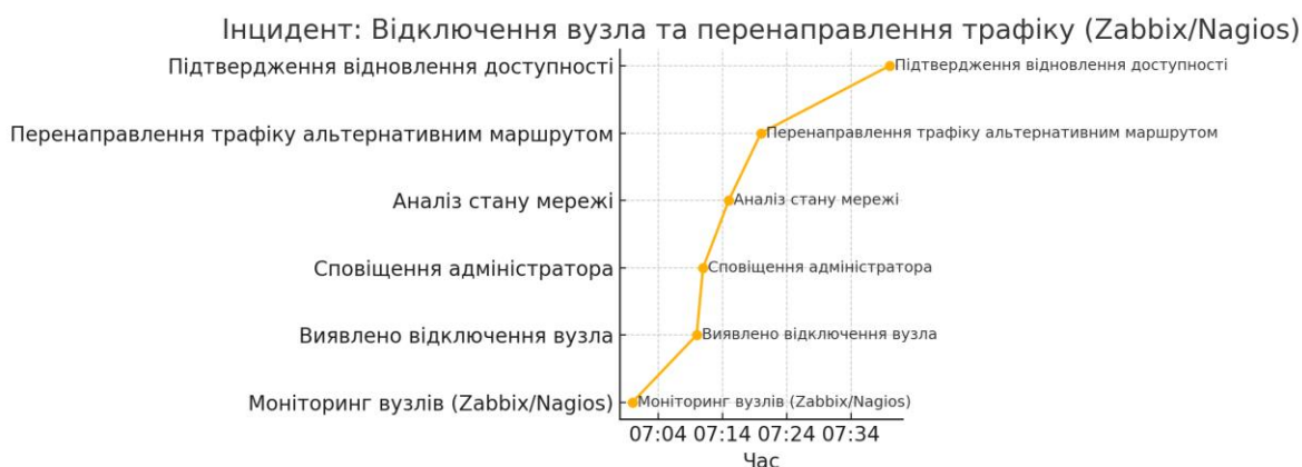
Рис. 3.8. – Реагування ISP на відключення вузла з подальшим перенаправленням трафіку через альтернативний маршрут
