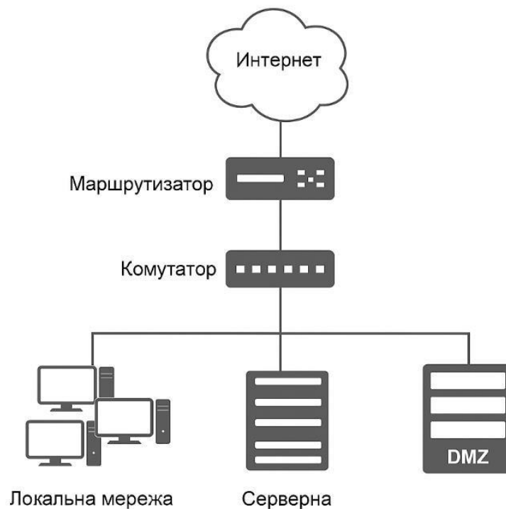
Рисунок 2.1 – Схема фізичної мережі підприємства (локальна мережа, серверна, доступ до інтернету)
