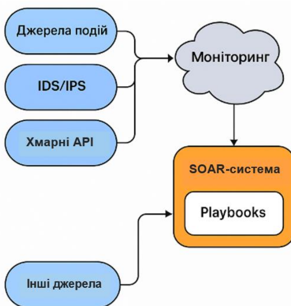
Рисунок 3.1 – Схема роботи автоматизованої системи реагування SOAR
