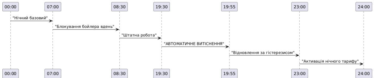
Рисунок 3.2 – Добовий графік активної потужності об'єкта автоматизації в інтелектуальному режимі (з увімкненим алгоритмом Load Shedding)
