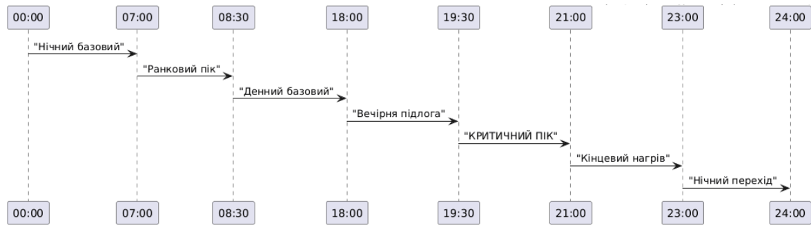
Рисунок 3.1 – Добовий графік активної потужності об'єкта автоматизації у некерованому режимі (без оптимізації)
