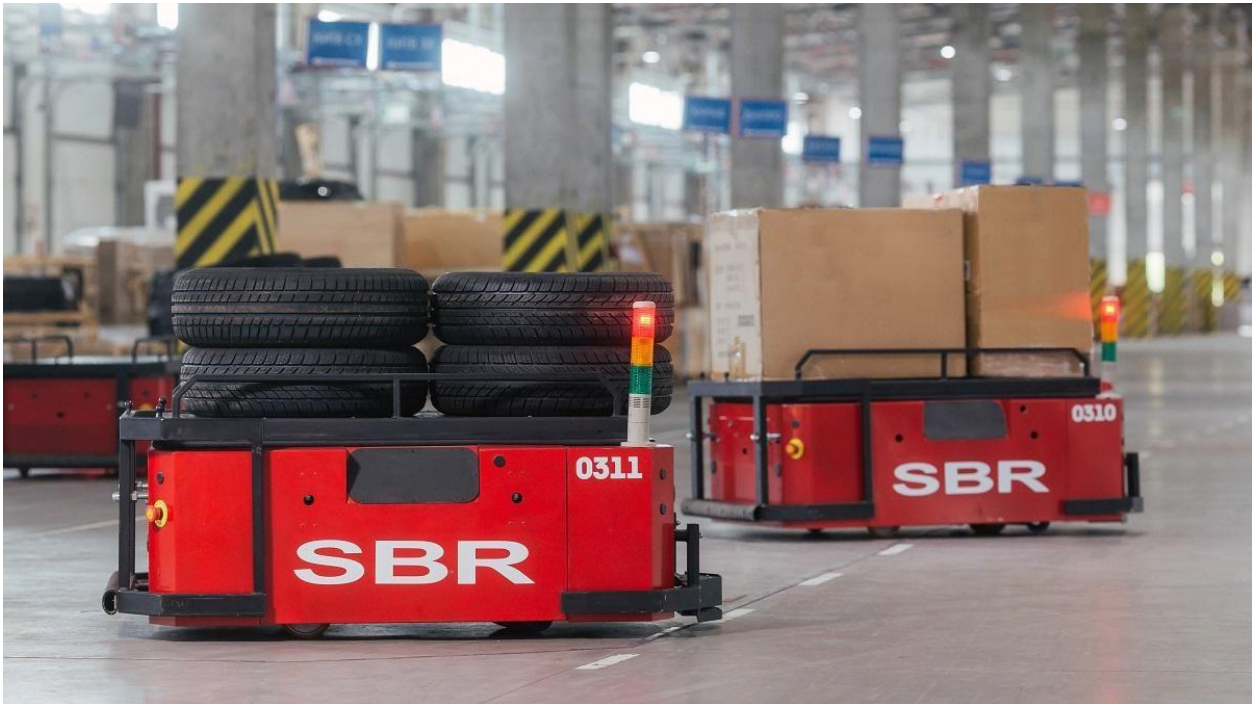
Рисунок 2.8. Deus Robots – робот-пірует для сортування відправлень
