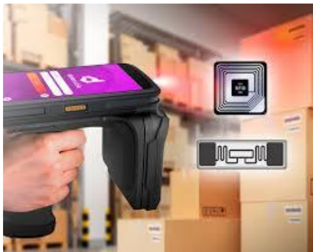
Рисунок 3.2. Ручний зчитувач RFID [39]
