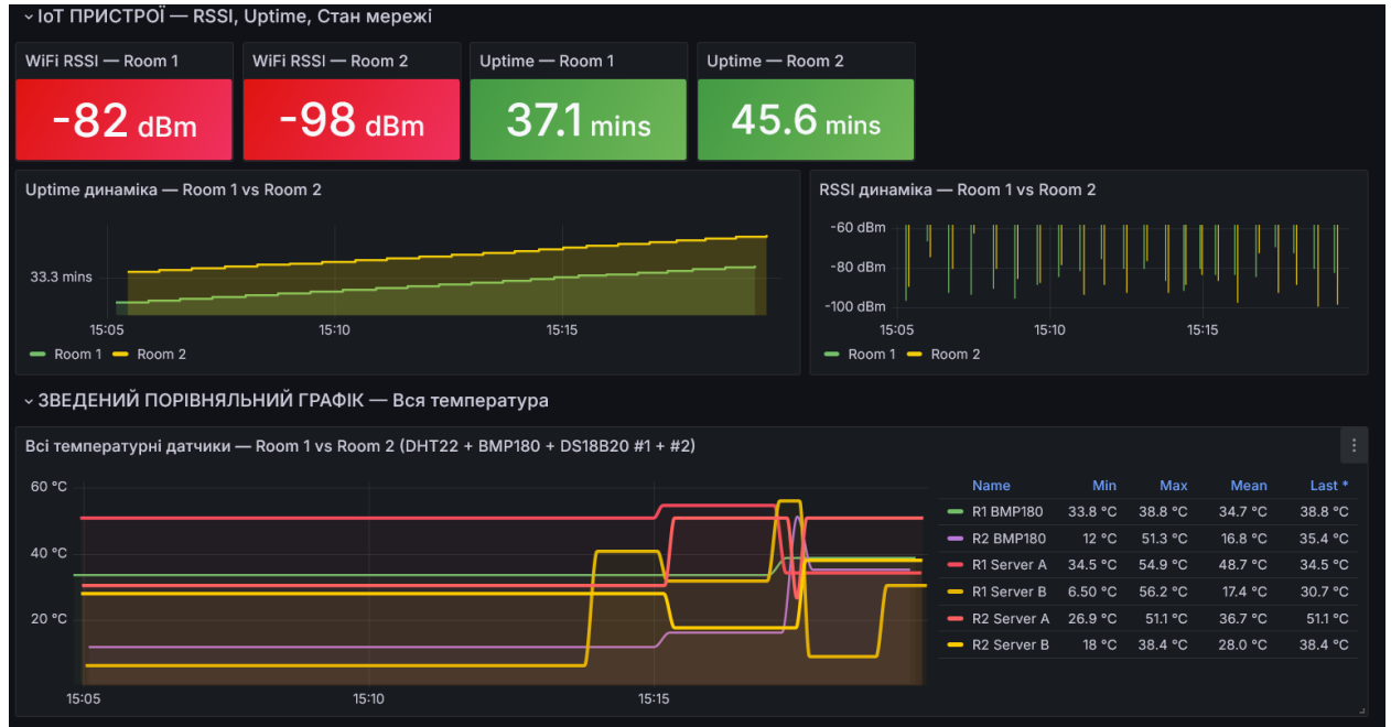
Рисунок 3.4 – Відображення параметрів телеметрії на дашборді Grafana після 30 хвилин стабільної роботи системи
