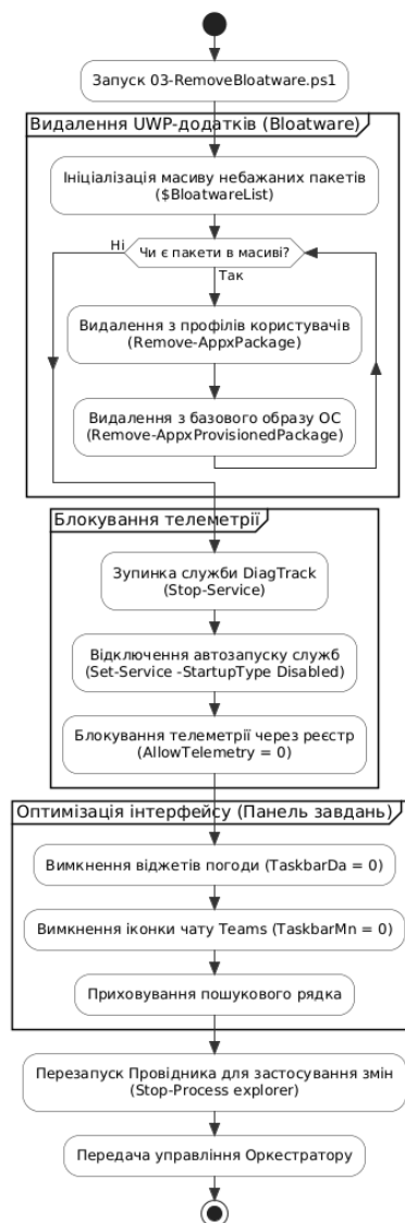
UML-діаграма діяльності скрипта оптимізації (03-RemoveBloatware.ps1)
