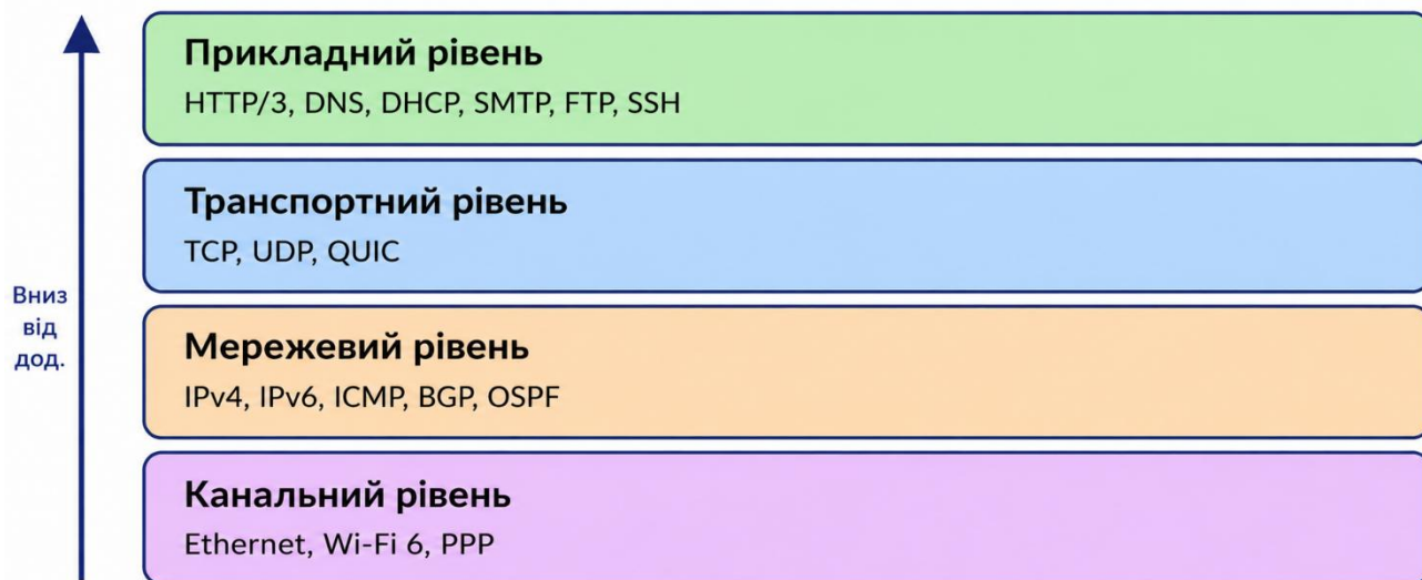
Рисунок 1.4 – Стек протоколів TCP/IP та класифікація прикладних процесів
