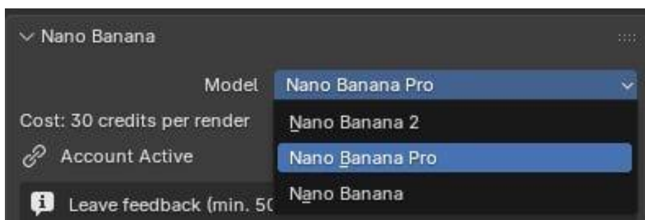
Рисунок 2.7 – Елемент EnumProperty для вибору моделі ШІ
