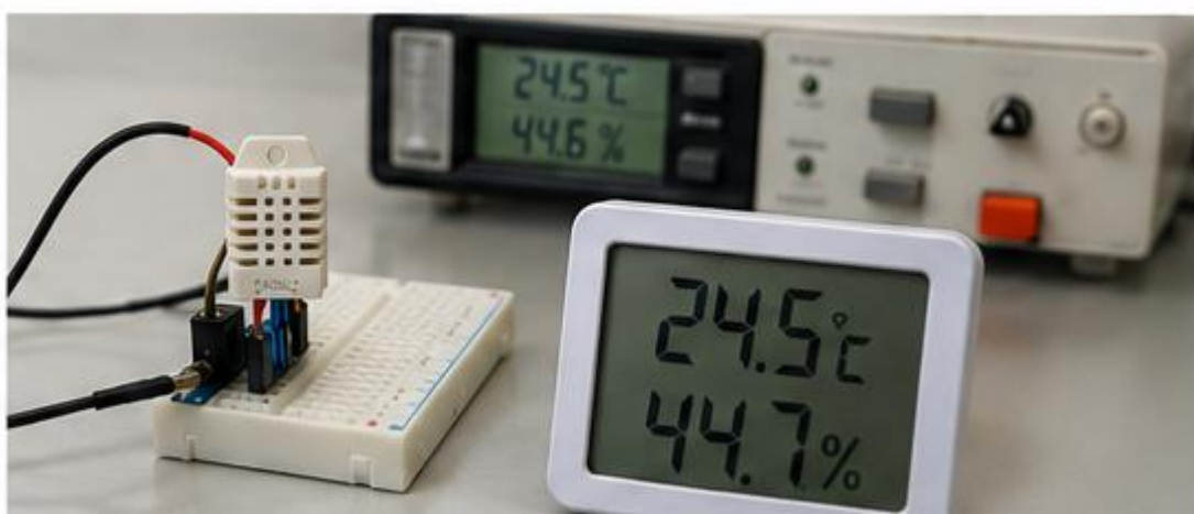
Рисунок 3.6 – Стенд для калібрування сенсорів та перевірки метрологічних характеристик вимірювального каналу
