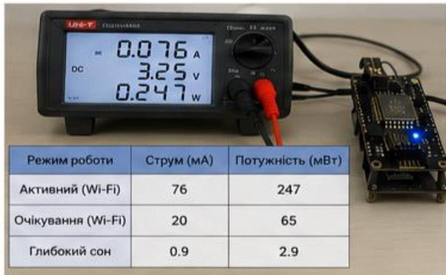
Рисунок 3.7 – Вимірювання енергоспоживання NodeMCU в різних режимах роботи
