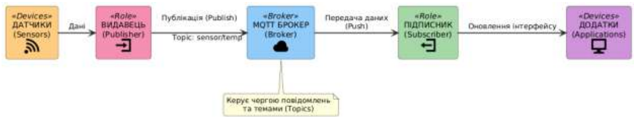
Рисунок 1.2 – Архітектура взаємодії компонентів у протоколі MQTT
