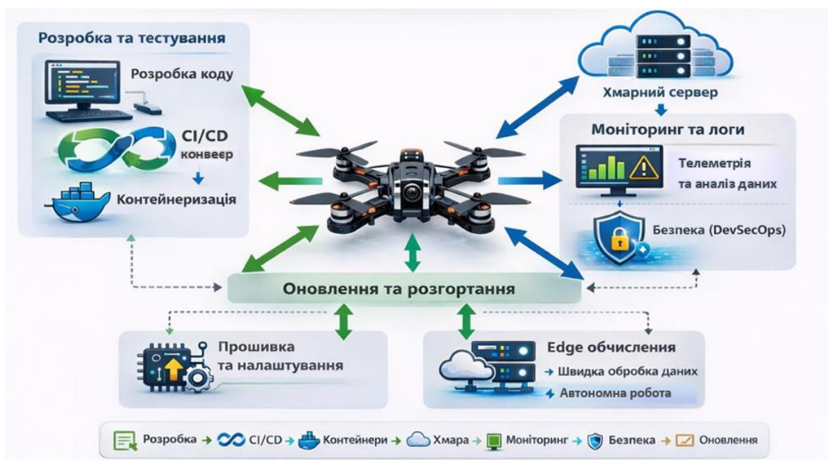
Рисунок 1 – Схема застосування DevOps у робототехнічній системі FPV-дрона
