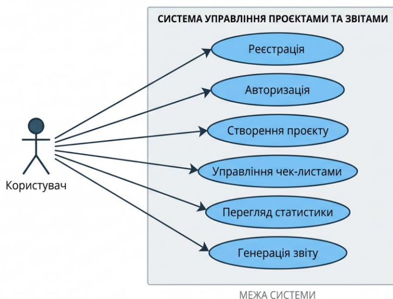
Рис. 2.2 — Діаграма прецедентів взаємодії користувача з системою
