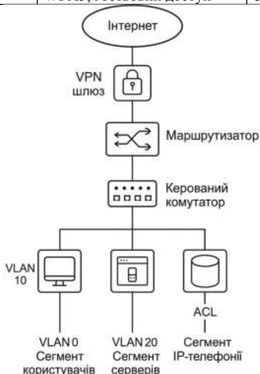
Рисунок 2.3 – Схема безпечної сегментованої LAN з VLAN, ACL і VPN
