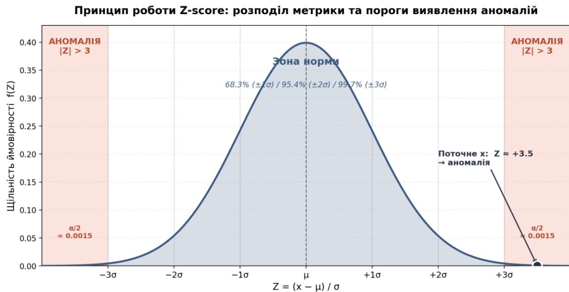
Рисунок 2.2 – Принцип роботи Z-score: розподіл значень метрики з порогоми виявлення аномалій
