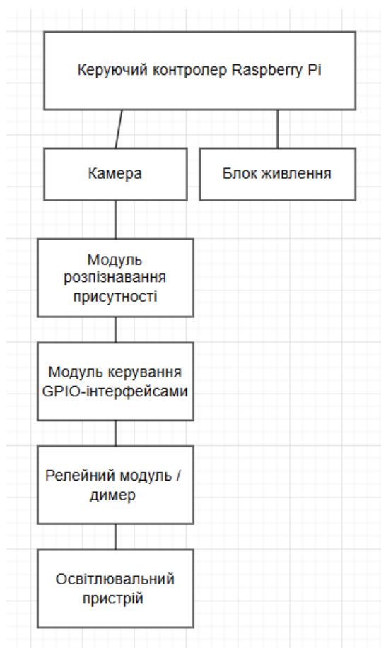
Рисунок 2.1 – Структурна схема системи управління освітленням
