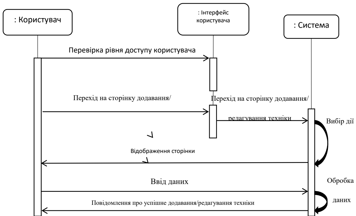
Рисунок 2.13 – Діаграма послідовності системи інвентаризації техніки на основі хмарних технологій
