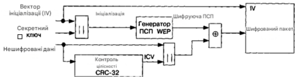
Рисунок 2.4 – Процес шифрування WEP
