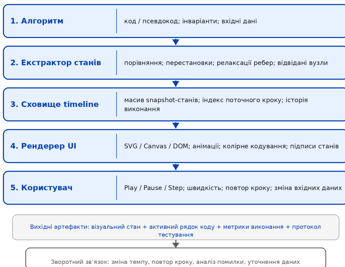
Рисунок 1.7 – Програмно-інженерний конвеєр перетворення алгоритму у візуалізовану послідовність станів
